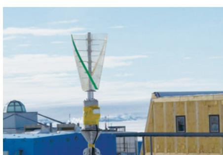
南極で稼働するスパイラルサボニウス風車(写真提供:国立極地研究所)
