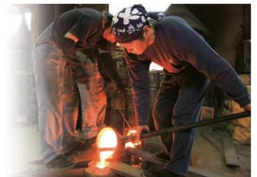
1400~1500℃に溶かした鉄を鑄型に流し込む「鑄込み」。(写真提供:株式会社岩鑄)
